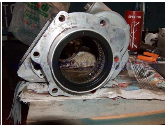
A sinistra è il gruppo cuscinetto posteriore - input gear, quest'ultimo è in perfette condizioni mentre a destra è il paraolio esterno e la gabbia a rulli su cui gira l'albero d'uscita. Il paraolio sembra nuovo, probabilmente era stato sostituito da poco tempo
