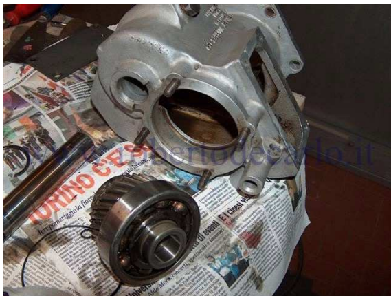
A sinistra è il gruppo cuscinetto posteriore - input gear, quest'ultimo è in perfette condizioni mentre a destra è il paraolio esterno e la gabbia a rulli su cui gira l'albero d'uscita. Il paraolio sembra nuovo, probabilmente era stato sostituito da poco tempo
