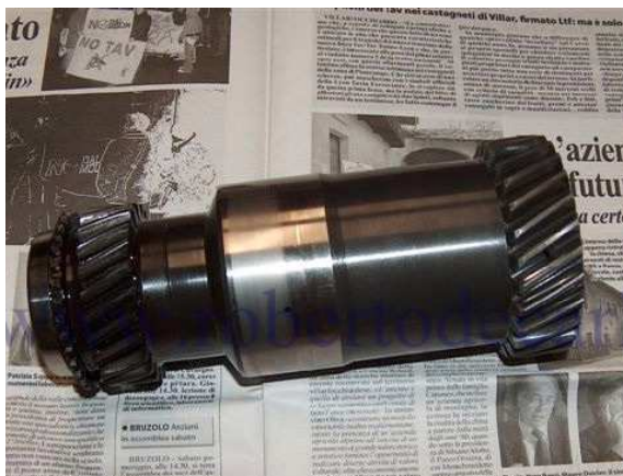
Albero d'uscita, l'ingranaggio a destra è quello che si inserisce nel riduttore, quello a sinistra fa presa sull'ingranaggio doppio ed è quello che presenta segni di grande usura visibili meglio nella foto a destra. È evidente come i denti dell'ingranaggio che ricevono il moto da quelli dell'ingranaggio doppio sono visibilmente usurati, in pratica la cementatura se n'è andata e la superficie presenta vistosi crateri che porteranno inevitabilmente all'aumento della rumorosità ed infine alla rottura di qualche dente.
